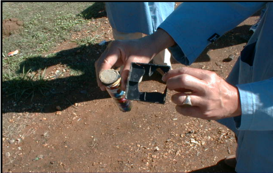
在标准委员会进行的测试中发生的底座脱离并碎裂的现象。
