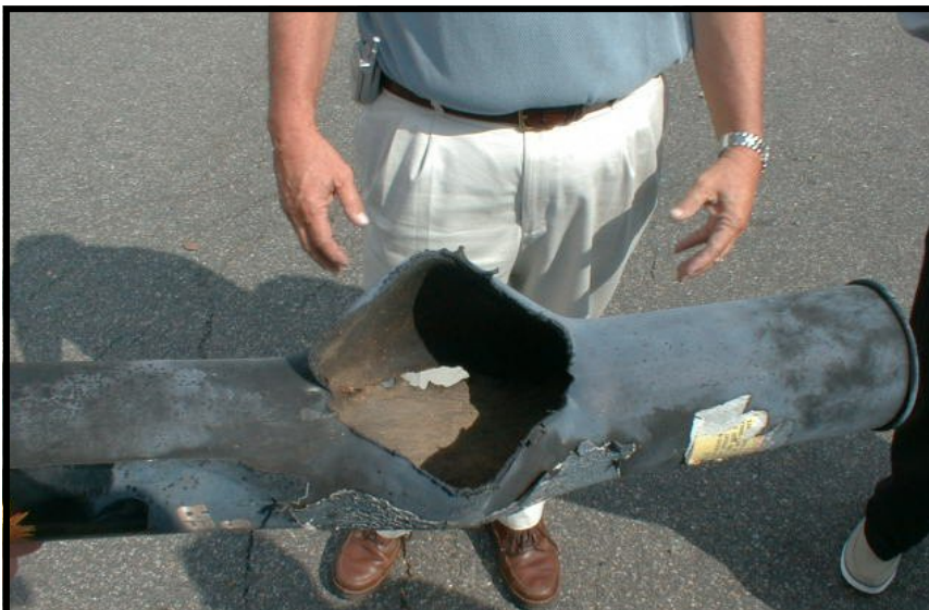
炮弹在筒内倒置爆炸造成塑料发射筒严重破裂和变形。
