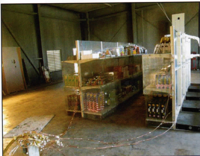
用于测试的消费品烟花零售货架, 装有隔火板和限制发射物装置。
