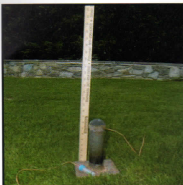
开爆药测试工具包括钢筒, 600 克钢球, 塑料瓶, 和量度尺。
